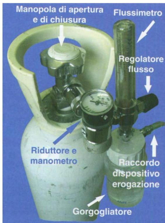
Figura 77. componenti del sistema di erogazione dell'ossigeno.
